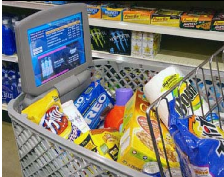
รูปที่ 1.10 รถเข็นซึ่งติดตั้งเครื่องอ่าน RFID จากสินค้าที่อยู่ในรถเข็น ทำให้ลูกค้าทราบราคาสินค้าที่ตนเองเลือกซื้อทั้งหมดจากหน้าจอ LCD และรายการโปรโมชั่นต่างๆ
